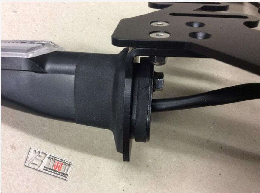
■ Schritt 7: Entfernen Sie der Spritzwasser schütz Platte und Leiten Sie die Kabel durch das Loch im Kennzeichenhalter.
