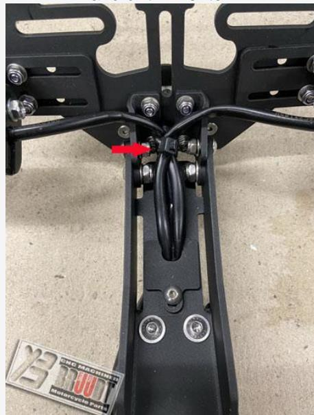
■ Schritt 8.: Entfernen Sie die 4 Mutter vom Kennzeichenhalter aber lassen Sie die 4 Distanz Buchsen sitzen. Begleiten Sie die Kabel durch das Loch im Heck und Montieren sie der
